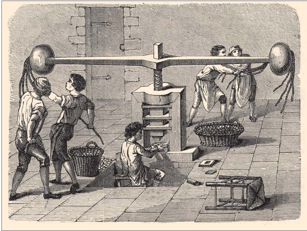
Балансир — винтовой пресс для чеканки монет (гравюра XIX века)
